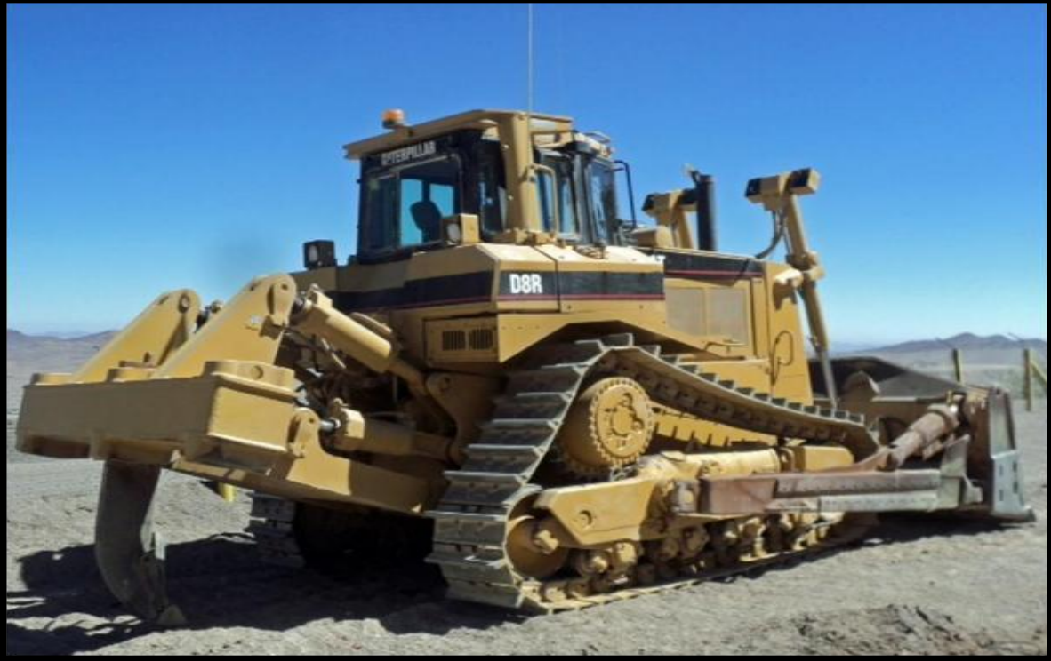
Engins de terrassement ( CATERPILLAR Bull D8R).
